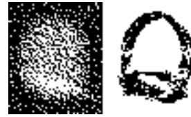
Рис. 1. Пример накладывающихся изображений двух объектов эллиптической формы (слева) и оптического потока от них (справа).
