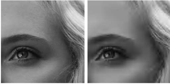
Рис. 4. Результаты тестирования алгоритмов на изображении «Скарлетт» с различными коэффициентами сжатия. Слева: K = 17 (ПОСШ = 38,25 дБ, УИК = 0,66, МЗ = 0,49, МР = 7,57, НИК2000 = 59,84). Справа: K = 100 (ПОСШ = 32,43 дБ, УИК = 0,43, МЗ = 0,86, МР = 12,76, НИК2000 = 40,03).
