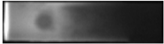
Рис. 2. Температурное поле поверхности пластины с дефектами, полученное с тепловизора.
