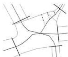
Рис. 6. Поиск границ элемента сопряжения, порожденного вершиной. Пунктиром показаны радиусы пустых кругов соседних точек одной из ветвей графа линейной модели.
