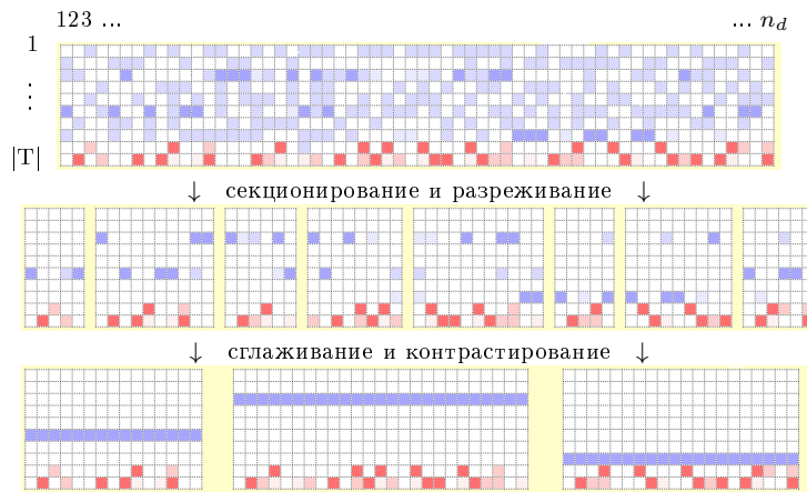
Рис. 24: Эвристическая пост-обработка матрицы \Pi_d = (p(t|d, w_i))_{T \times n_d} на E-шаге для выделения тематически однородных сегментов текстового документа d = (w_1, \dots, w_{n_d}) . Предметные темы (синие) подвергаются сглаживанию и разреживанию, затем контрастируются доминирующие темы сегментов. Фоновые темы (две последние, красные) не участвуют в пост-обработке.
