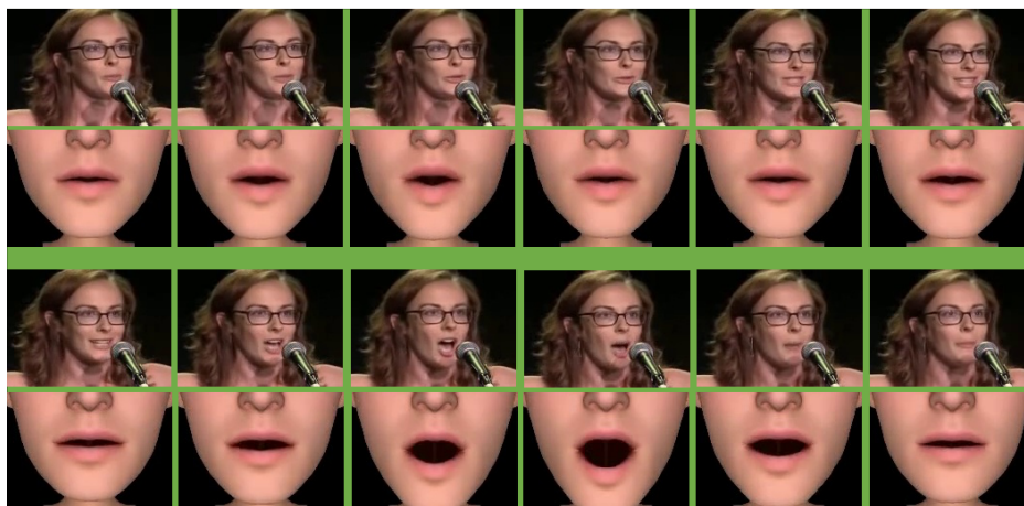
Рис. 5.2. Визуализация результатов. Актриса произносит фразу "...music up". Кадры взяты с частотой 15 кадров в секунду. Анимирование сделано с учетом запаздывания в 130 мс.
