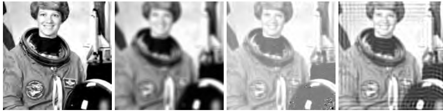
Рис. 2.1: Пример работы простых алгоритмов в ситуации нарушения предположений их моделей (яркость на картинке частично затухает). Слева-направо: исходное изображение, размытое изображение, восстановленное алгоритмом Люси-Ричардсона, восстановленное алгоритмом Вейнера. Видно, что алгоритмы либо выдают слишком размытое изображение, либо добавляют артефакты-кольца.
