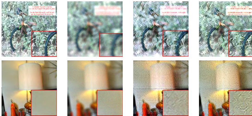
Рис. 4.8: Результат работы третьей предложенной модели. Слева-направо: исходное изображение, размытое изображение, восстановленное методом №2, восстановленное методом №3. Видно, что изображения становятся более резкими, но резкость все еще достигается за счет равномерного зашумления изображений.
